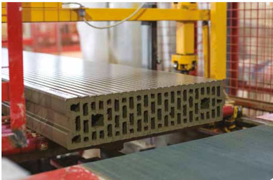
| Процесс формовки керамических блоков «КЕТРА»
